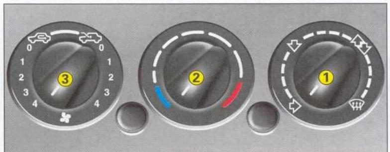
La répartition de l'air pulsé peut être modulée à volonté en plaçant le répartiteur **1** sur une position intermédiaire. Quelle que soit la position choisie, il est toujours possible d'obtenir de l'air aux aérateurs.
