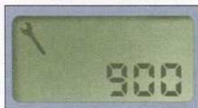
Quelques secondes après la mise du contact, le totalisateur kilométrique reprend son fonctionnement normal et **la clé de maintenance reste allumée.**
